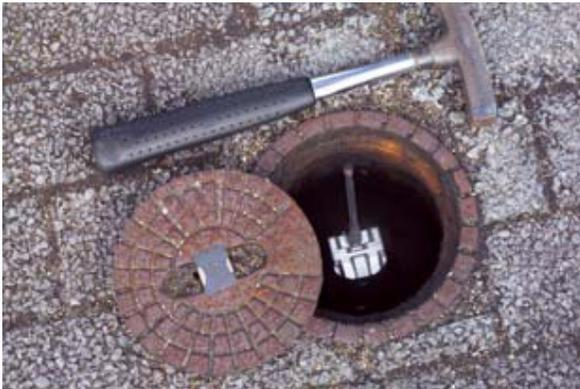
*SePem 01 instalado en posición vertical*
