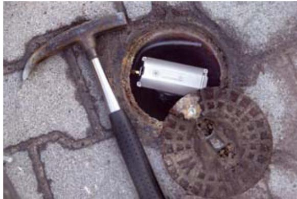
*SePem 01 instalado en posición horizontal*
